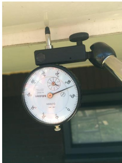
Figuur 11 en 12 Meetsklok met de af te lezen waarde van 0,84 mm doorbuiging bij de maximale belasting van 25 cm water.
